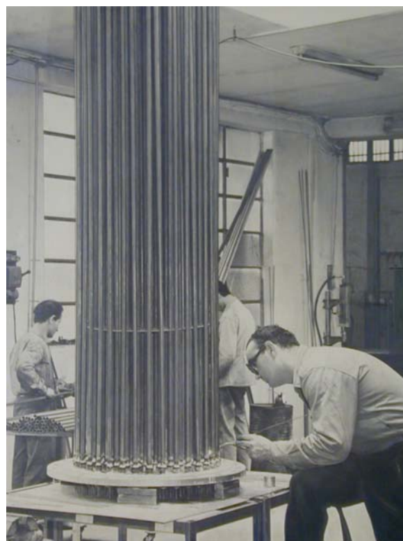
Sudura prin brazare a primului incalzitor cu flansa Anul 1967
